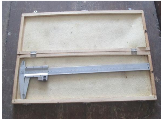
Gambar 13. Jangka sorong ketelitian 0,05 mm.
