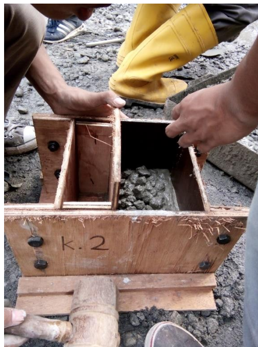
Gambar 51. Pencetakan beton substrate
