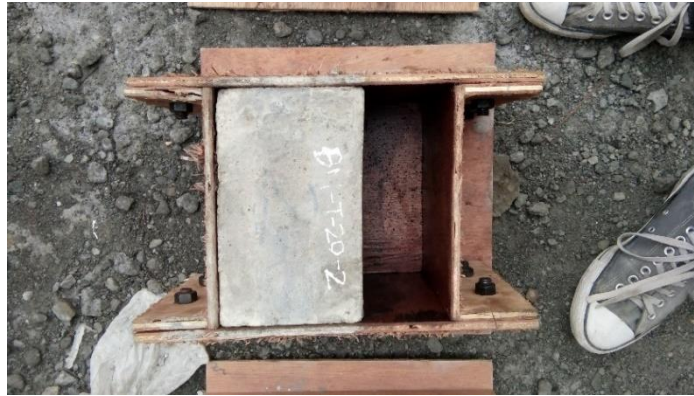
Gambar 52. Persiapan begesting dan setting beton substrate sebelum ditambah overlay
