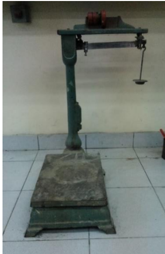
Gambar 30. Timbangan dengan kapasitas 50 kg
