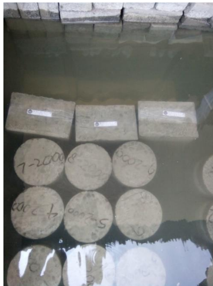
Gambar 55. Perawatan beton dengan perendaman
