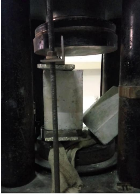
Gambar 59. Keruntuhan setelah pembebanan
