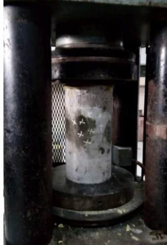
Gambar 56. Pengujian kuat tekan silinder beton
