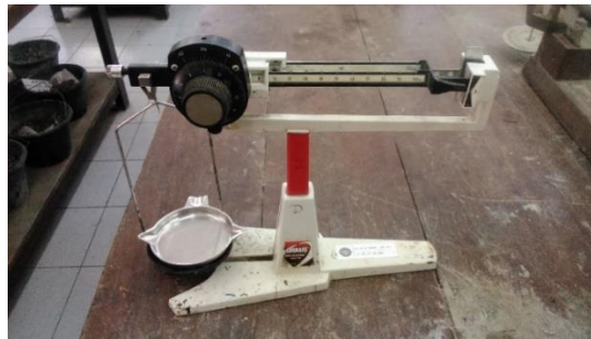
Gambar 31. Timbangan dengan kapasitas 310 gram
