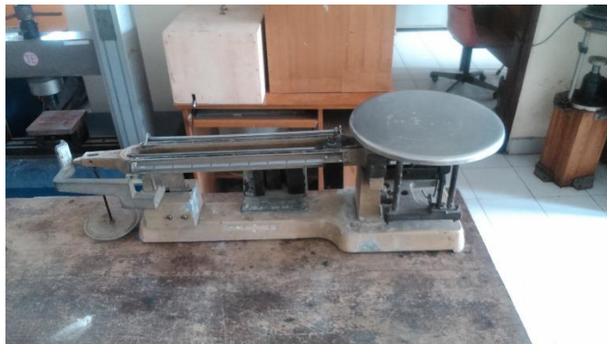
Gambar 29. Timbangan dengan kapasitas 10 kg
