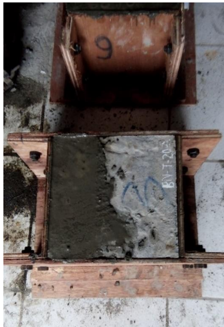
Gambar 53. Pencetakan beton overlay
