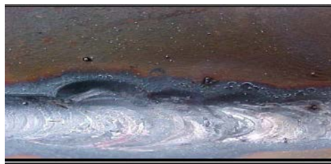
Gambar 30. Cacat pengelasan undercut (Anonim,tt)
