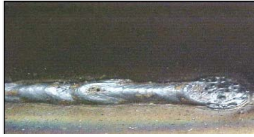
Gambar 28. Cacat pengelasan porositas (Anonim,tt)
