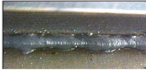
Gambar 29. Cacat pengelasan incomplet fusio (Anonim,tt)
