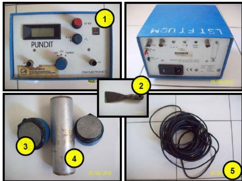
Gambar 35. Peralatan uji UPV (Sumber: Faqih, 2010)
