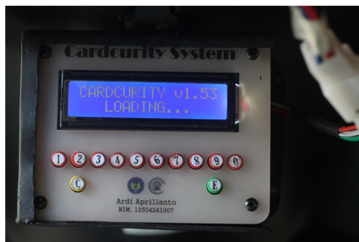
Gambar 71. Tampilan LCD dari Cardcurity System
