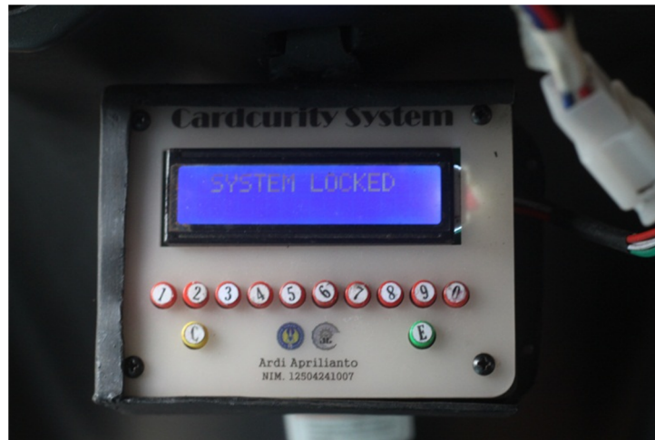
Gambar 81. Tampilan sistem terkunci setelah alarm berbunyi
