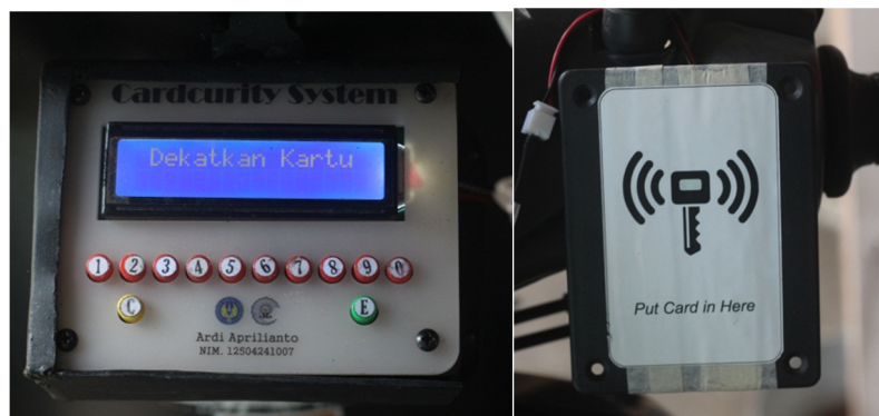
Gambar 73. Langkah pengujian untuk pendeteksian kartu
