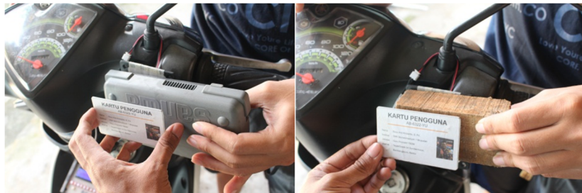
Gambar 76. Pendeteksian kartu saat sensor terhalang benda
