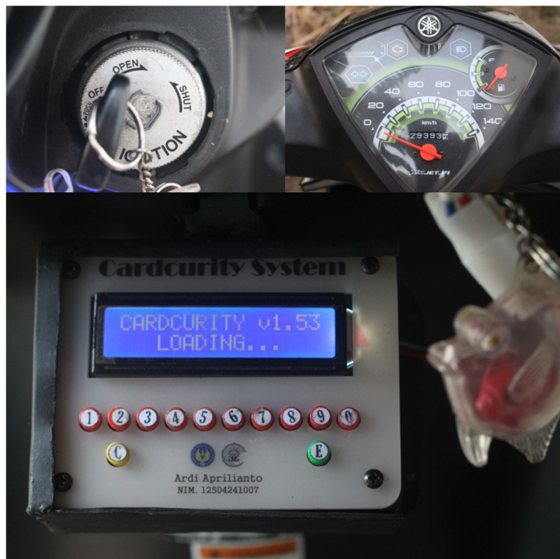
Gambar 69. Posisi kunci kontak ON dan lampu check engine tidak menyala
