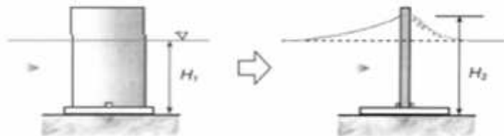
Gambar 5. Pengukuran Kecepatan Arus dengan Velocity Head Rod
