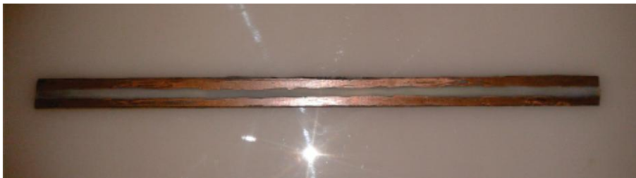
Gambar 13. Jalur PCB sebagai busbar
