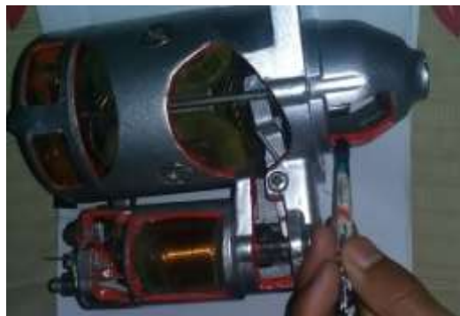
Gambar 42. Mengecat Motor Starter.
