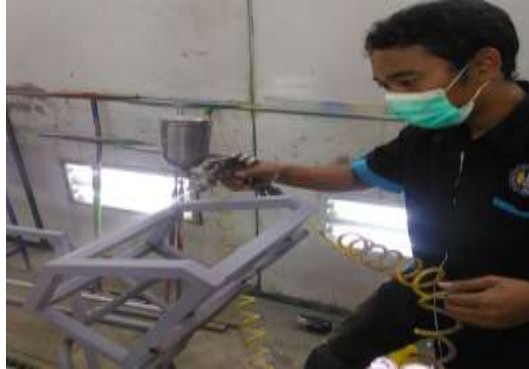
Gambar 40. Menyemprotkan Cat Dasar atau Primer.
