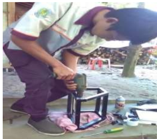
Gambar 51. Mengebor Rangka Samping dan Belakang.
