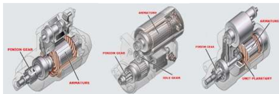
Gambar 6. Motor Starter Konvensional, Reduksi dan Planetary.
