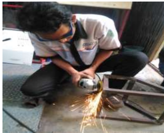
Gambar 39. Membersihkan Rangka yang Berkarat.
