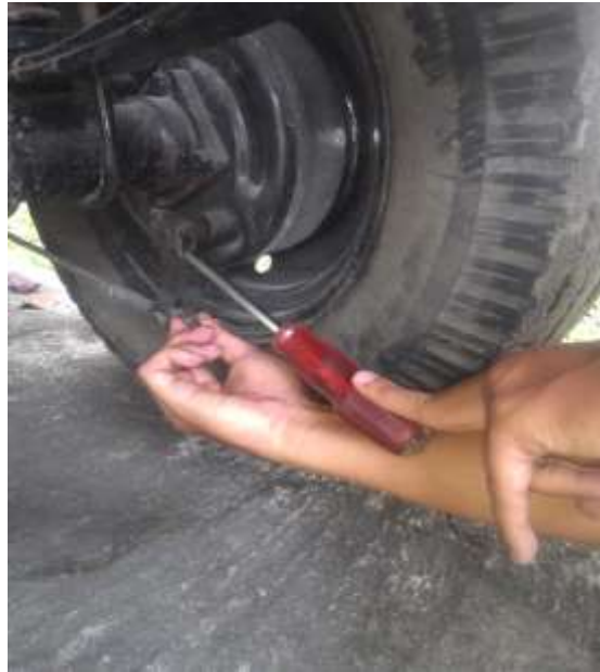
Gambar 61. Penyetelan Rem Belakang
