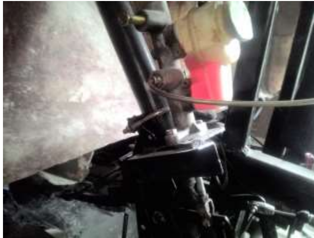
Gambar 54. Pemasangan Master Silinder
