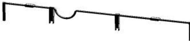
Gambar 23. Penghubung Rem Belakang
