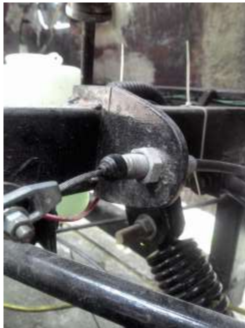
Gambar 58. Pemasangan Dudukan Rem
