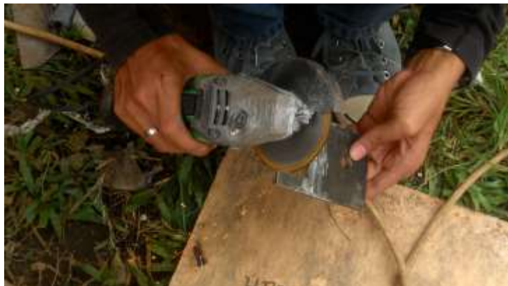
Gambar 41. Merapikan Dudukan Pengait Kabel Rem
