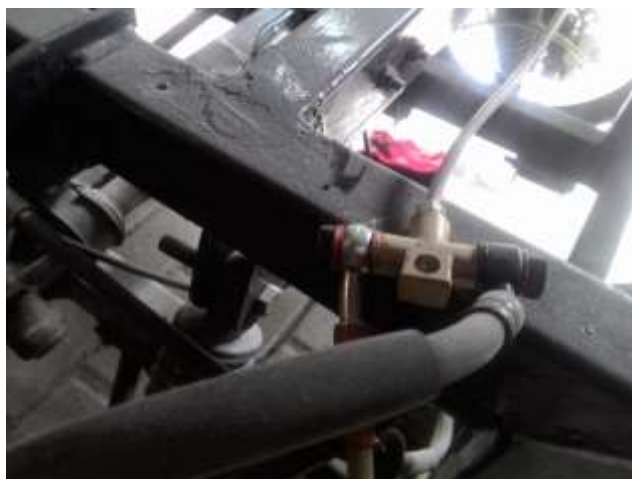
Gambar 55. Pemasangan T Pembagi
