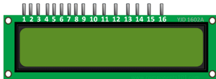
Gambar 14. Konfigurasi Pin LCD 16x2 karakter (Anonim, 2008)
