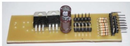
Gambar 26. Realisasi rangkaian regulator
