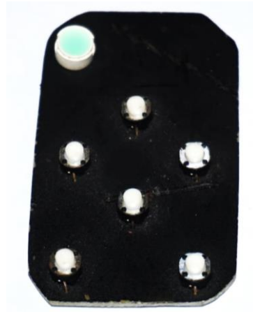
Gambar 35. Realisasi rangkaian Keypad
