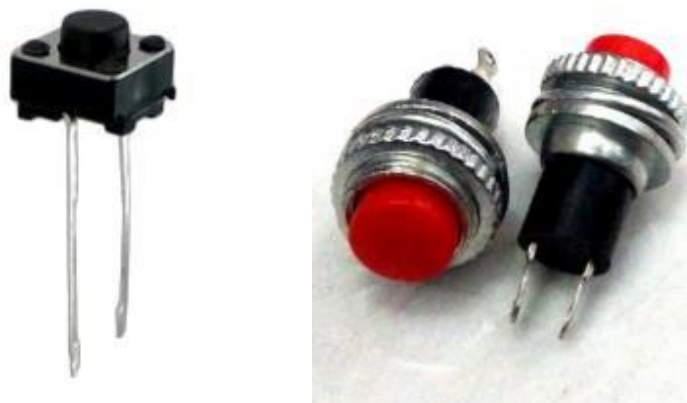
Gambar 13. Bentuk Push-button PTM (Caang Go, 2011)
