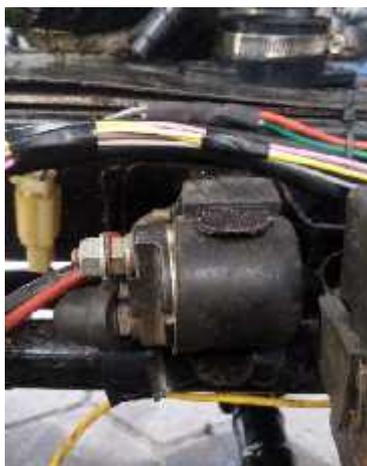
Gambar 52. *Relay Starter* Setelah Dipasang Pada Dudukan
