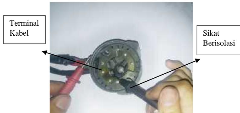
Gambar 45. Pemeriksaan Terminal Kabel Dengan Sikat Berisolasi
