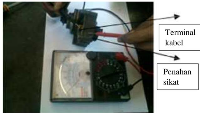
Gambar 44. Pemeriksaan Hubungan Terminal Kabel dan Pemegang Sikat
