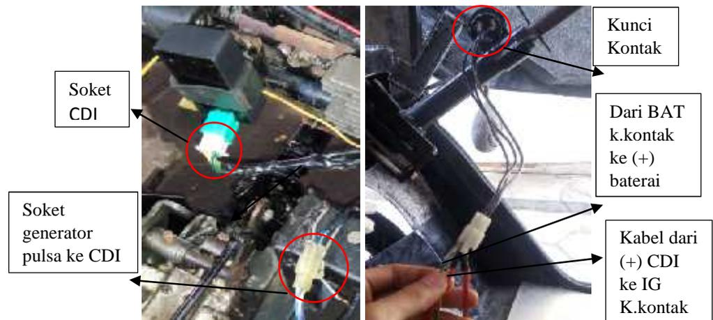
Gambar 78. Sambungan Soket dan Rangkaian Kabel IG
