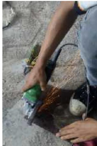
Gambar 48. Pemotongan Plat L
