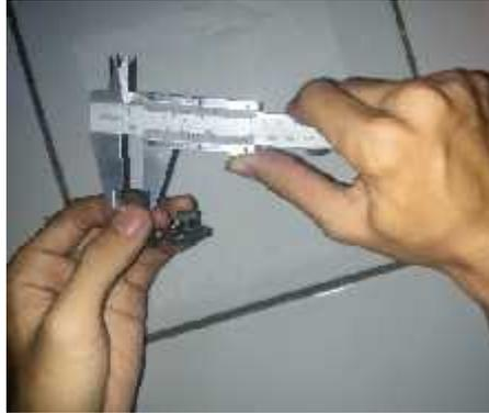
Gambar 42. Pengukuran Panjang Sikat
