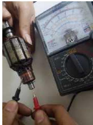
Gambar 41. Pemeriksaan kumparan *komutator* dengan poros *armature*
