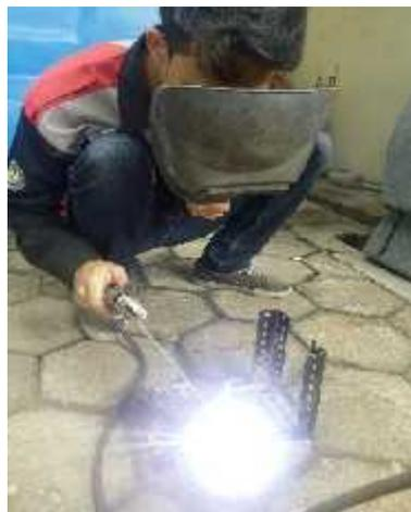
Gambar 49. Pengelasan Besi Siku Lubang
