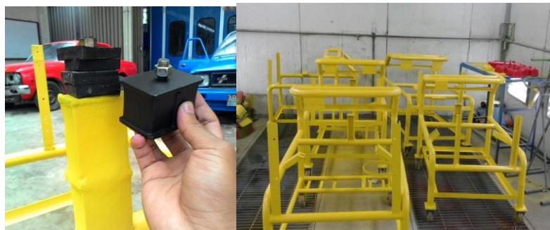
Gambar 70. Hasil Perbaikan Rangka Engine Stand dan Penggantian Engine Mounting
