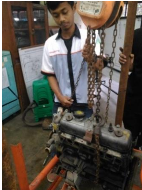
Gambar 60. Proses Melepas dan Menurunkan Engine
