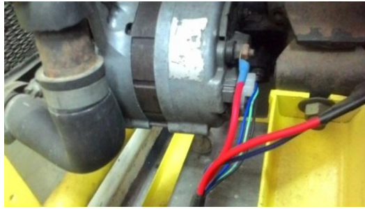
Gambar 75. Hasil Penggantian Alternator Konvensional
