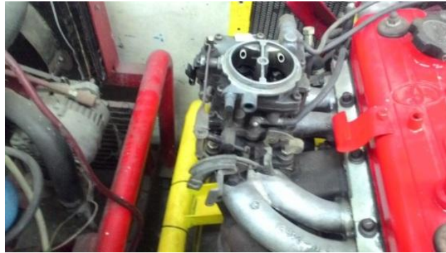
Gambar 71. Hasil Penggantian Intake dan Karburator
