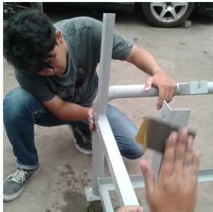
Gambar 64. Proses Pengamplasan Permukaan Lapisan Primer
