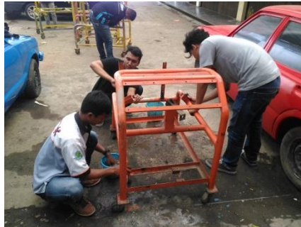
Gambar 61. Proses Persiapan Permukaan Rangka
