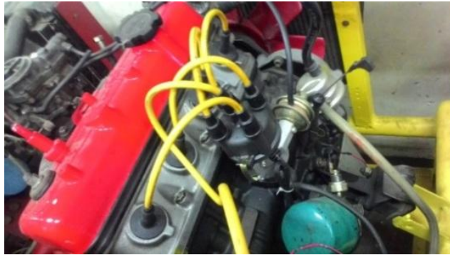
Gambar 73. Hasil Penggantian Distributor Elektronik
