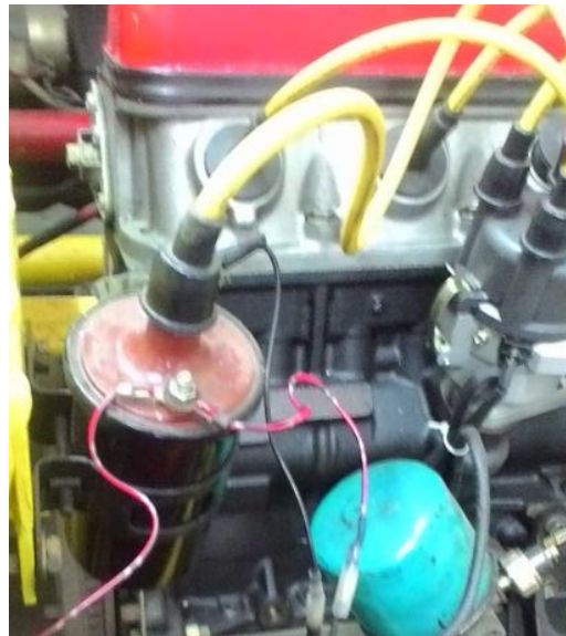
Gambar 74. Hasil Penggantian Coil Konvensional
