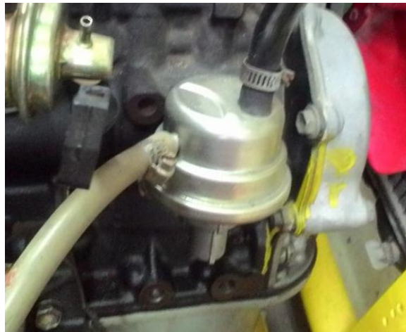
Gambar 72. Hasil Penggantian Pompa Konvensional
