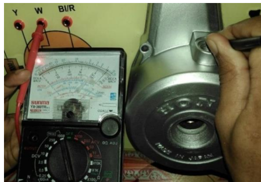
Gambar 44. Pengecekan Kumbaran Pengisian Alternator
