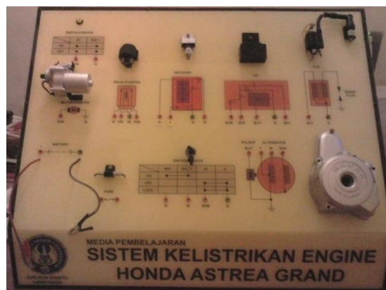
Gambar 37. Hasil Perakitan Komponen Pada Papan Acrylic
