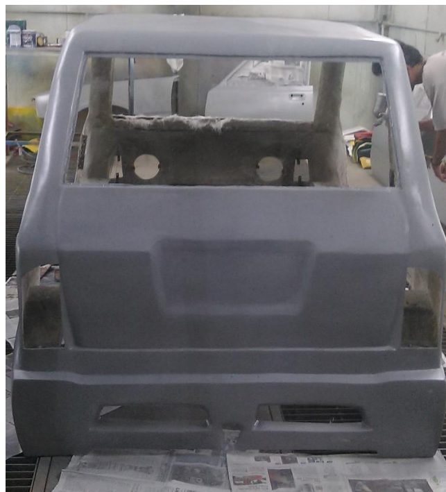
Gambar 26. Kendaraan Saat di Epoxy
