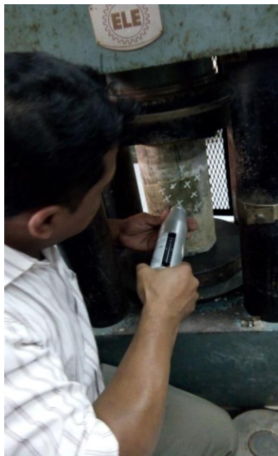
Gambar 37. Pengujian hammer test
