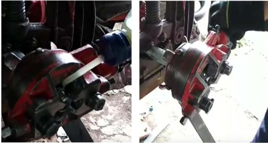
Gambar 17. Proses pembuatan ulir pipa
