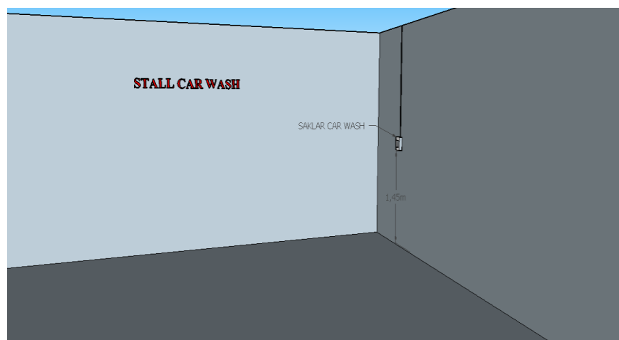
Gambar 12. desain tata letak saklar dibagian stall Car Wash .
