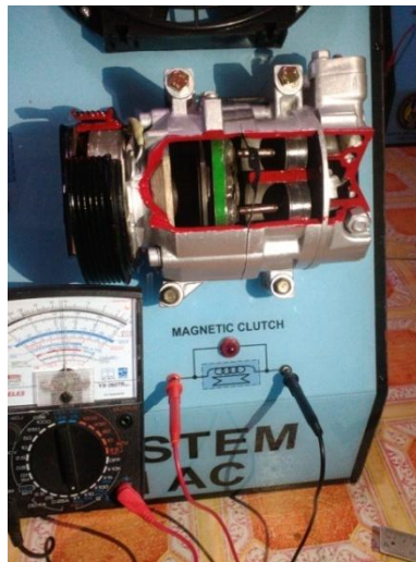
Gambar 81. Pemeriksaan Kontinuitas pada Kumparan Magnetic Clutch
