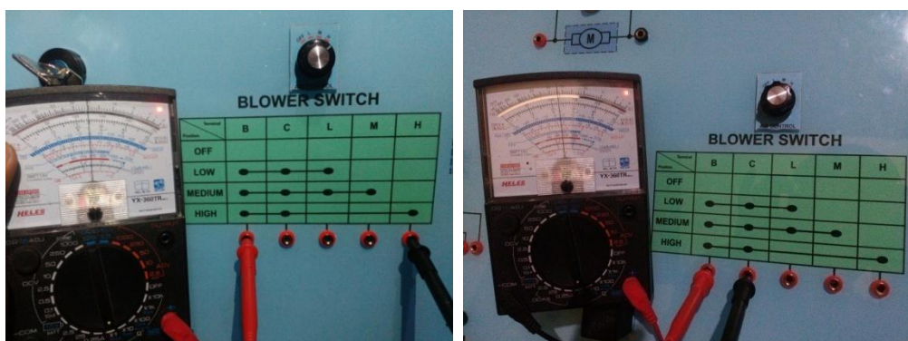
Gambar 76. Pemeriksaan Kontinuitas pada Posisi H ( High )
