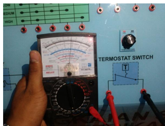
Gambar 77. Pemeriksaan Kontinuitas pada Posisi ON
