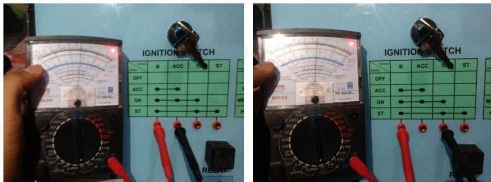
Gambar 72. Pemeriksaan Kontinuitas Ignition Switch pada Posisi ON
