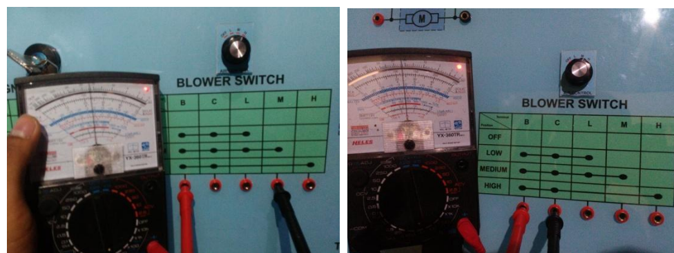
Gambar 75. Pemeriksaan Kontinuitas pada Posisi M ( Medium )
