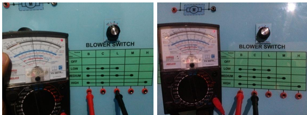
Gambar 74. Pemeriksaan Kontinuitas pada Posisi L ( Low )
