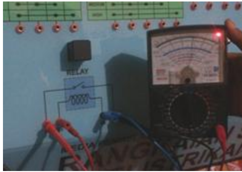
Gambar 79. Pemeriksaan Kontinuitas pada Relay
