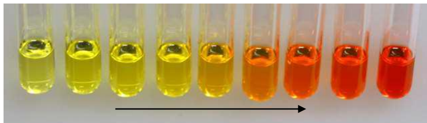
Gambar 2. Warna nanopartikel bergantung pada ukuran partikelnya ( Oldenburg, 2011)
