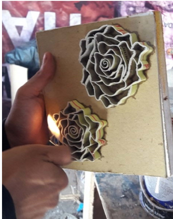
Gambar LII: Memperbaiki permukaan canting cap dengan dibakar sebentar (Sumber: Dokumentasi Tri Nur Dwi Asih, Februari 2018)
