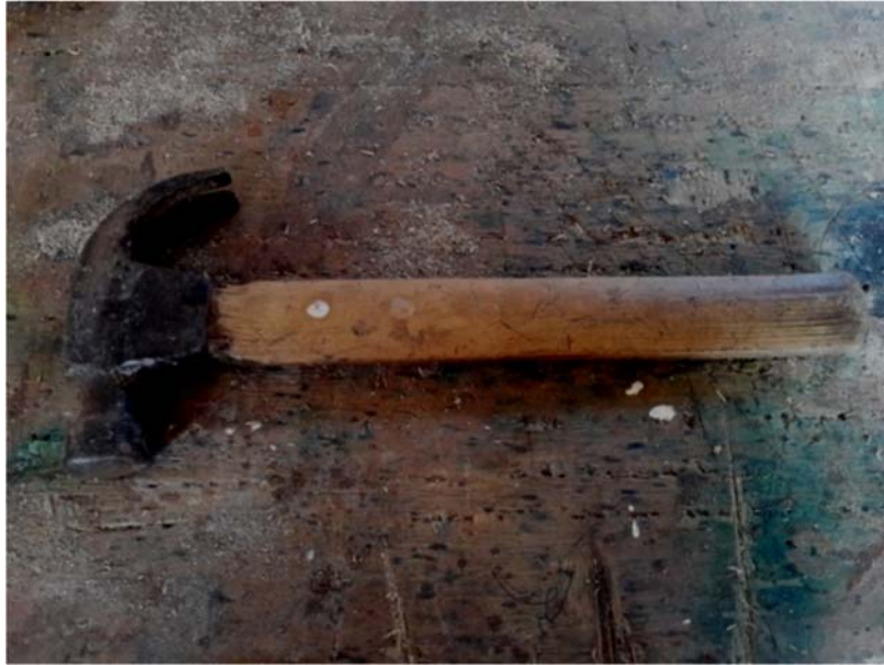
Gambar XXXII: Palu di Omah Kreatif Dongaji digunakan untuk memukul paku saat membuat pegangan pada canting cap (Sumber: Dokumentasi Tri Nur Dwi Asih, Februari 2018)
