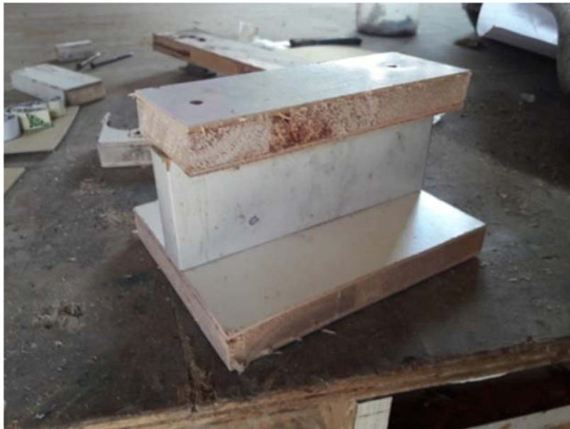
Gambar XLVIII: Dasaran dengan pegangan canting cap siap digunakan
