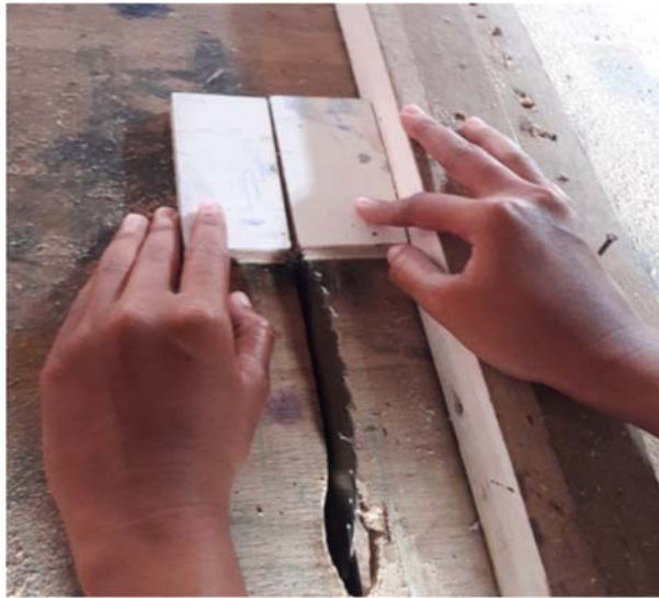
Gambar XLVI: Memotong kayu menggunakan gergaji untuk pegangan canting cap sesuai ukuran
