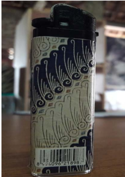
Gambar XXXIII: Korek gas di Omah Kreatif Dongaji digunakan untuk menjadikan ketebalan kertas limbah seperti semula setelah diampelas dengan cara dibakar sebentar
