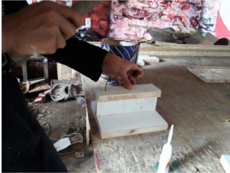
Gambar XLVII: Memaku pegangan canting cap dengan dasaran kayu agar lebih kuat
