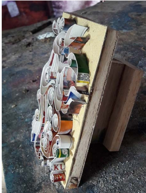
Gambar LXIII: Canting cap berbahan limbah kertas kemasan ergonomis untuk digunakan
