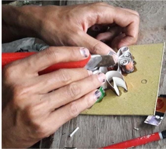
Gambar XLIV: Merapikan permukaan dan sambungan pada permukaan canting cap menggunakan cutter
