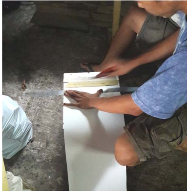
Gambar LXVIII: Membuat bilah-bilah kertas tidak dapat stabil ukurannya, karena masih manual
