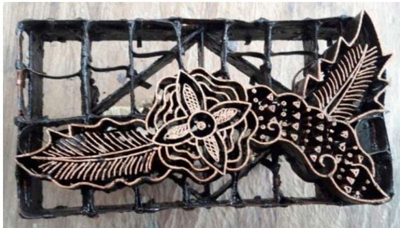
Gambar I: Permukaan canting cap berbahan tembaga (Sumber: Dokumentasi Tri Nur Dwi Asih, Maret 2018)
