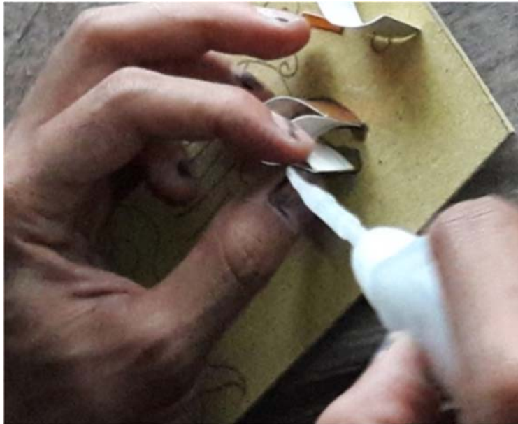
Gambar XLII: Mengelem potongan bilah kertas pada dasaran canting cap (kertas karton tebal) dengan posisi berdiri dan saling menyambung dengan bilah kertas yang lain
