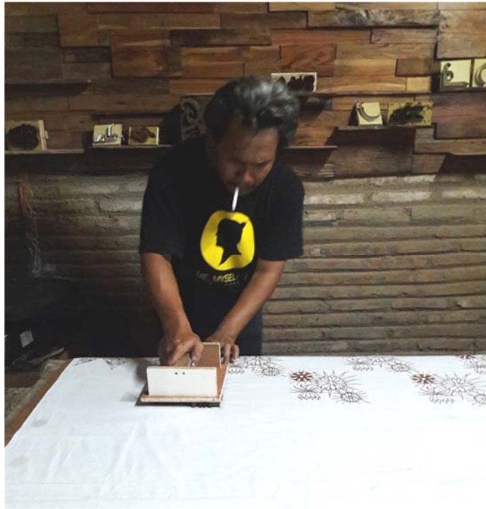
Gambar LVIII: Setiap canting cap berbahan limbah kertas kemasan memiliki titik pada tiap ujungnya untuk mempermudah proses pengecapan (Sumber: Dokumentasi Tri Nur Dwi Asih, Januari 2018)
