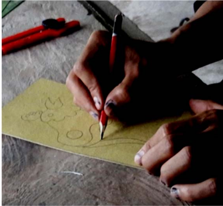
Gambar XXXIV: Menggambar motif yang akan dibuat canting cap di atas kertas karton
