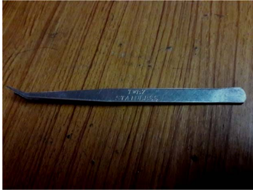
Gambar XXIX: Pinset di Omah Kreatif Dongaji digunakan untuk membantu memegang bilah kertas yang berukuran kecil pada saat proses mengukur dan mengelem
