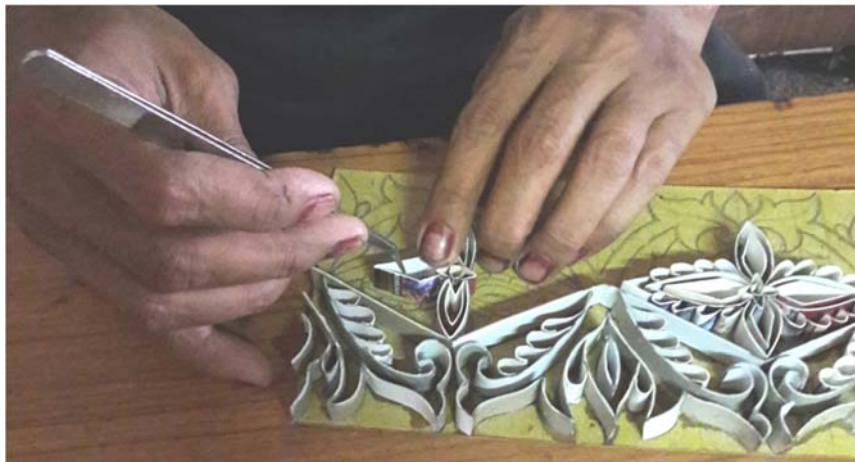
Gambar LXVI: Proses pembuatan canting cap berbahan limbah kertas kemasan menggunakan teknik sederhana sehingga mudah dibuat (Sumber: Dokumentasi Tri Nur Dwi Asih, Maret 2018)
