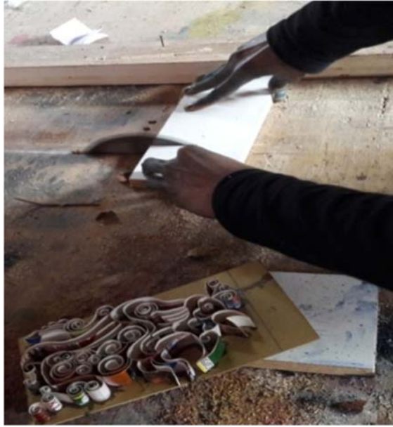
Gambar XLV: Memotong kayu menggunakan gergaji untuk dasaran canting cap sesuai ukuran
