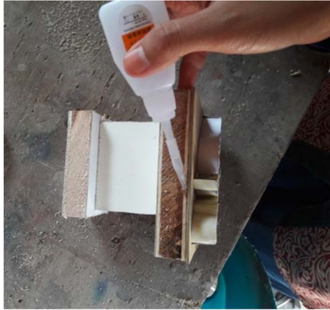
Gambar XLIX: Mengelem dasaran kayu dengan dasaran kertas karton menggunakan lem
