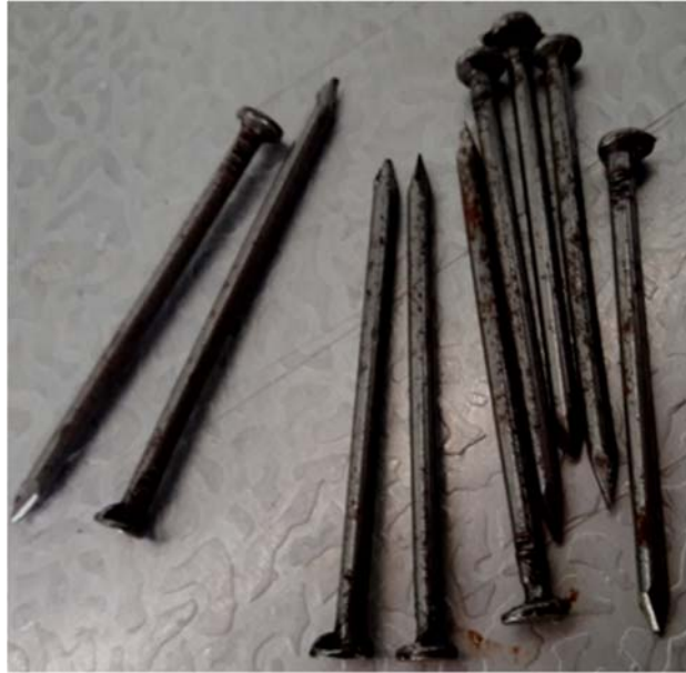
Gambar XXV: Paku di Omah Kreatif Dongaji digunakan untuk menyatukan pegangan dengan dasaran canting cap (Sumber: Dokumentasi Tri Nur Dwi Asih, Maret 2018)
