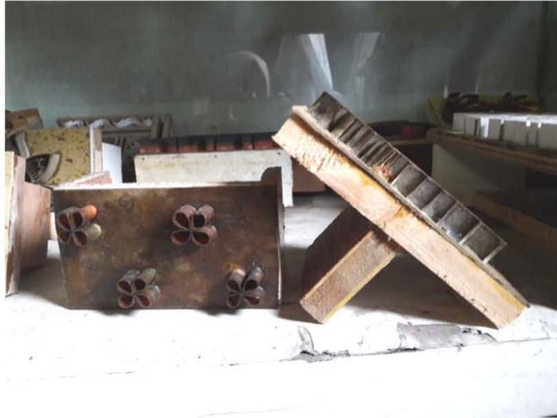
Gambar LXIX: Canting cap berbahan limbah kertas kemasan tidak dapat seawet canting cap berbahan tembaga (Sumber: Dokumentasi Tri Nur Dwi Asih, Januari 2018)
