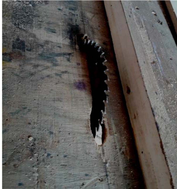
Gambar XXXI: Gergaji mesin di Omah Kreatif Dongaji digunakan untuk memotong kayu sebagai dasaran dan pegangan canting cap (Sumber: Dokumentasi Tri Nur Dwi Asih, Februari 2018)
