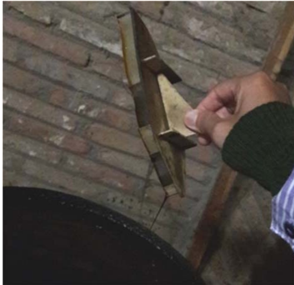
Gambar LIV: Untuk mengetahui canting cap siap digunakan dengan mengangkatnya dari loyang dan malam cair dapat mengalir ke bawah (Sumber: Dokumentasi Tri Nur Dwi Asih, Mei 2018)
