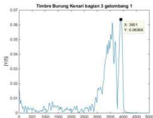
Gambar 4.23. Spektrum dari ragam peak frekuensi Kenari dengan peak frekuensi 3901Hz.
