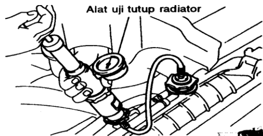
Gambar 25. Pemeriksaan kebocoran pada sistem pendingin
