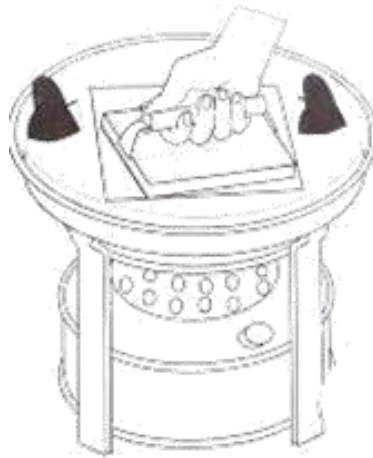
Gambar 16: Memanaskan Canting Cap pada Wajan
