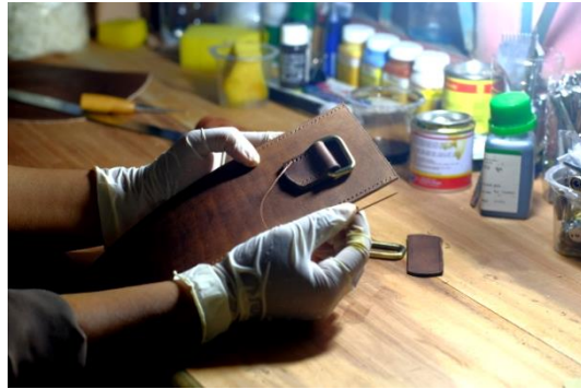
Gambar 96. Proses Menjahit Ring Tas (Dokumentasi Nova Mardiaty 2017)
