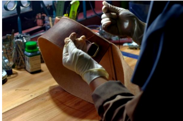
Gambar 101. Proses Menjahit Bagian Tas (Dokumentasi Nova Mardiaty 2017)
