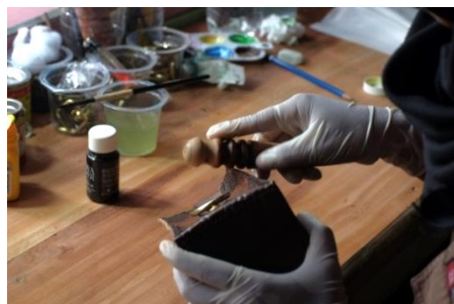
Gambar 110. Proses Menggosok Tepi Tas Menggunakan Slikker (Dokumentasi Nova Mardiaty 2017)
