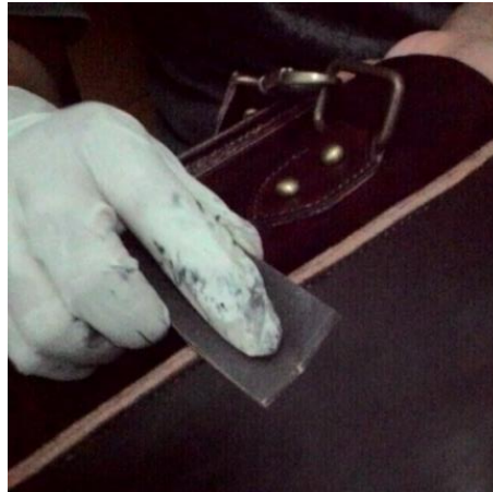
Gambar 108. Menggosok Pinggiran Tas dengan Amplas (Dokumentasi Nova Mardiaty 2017)
