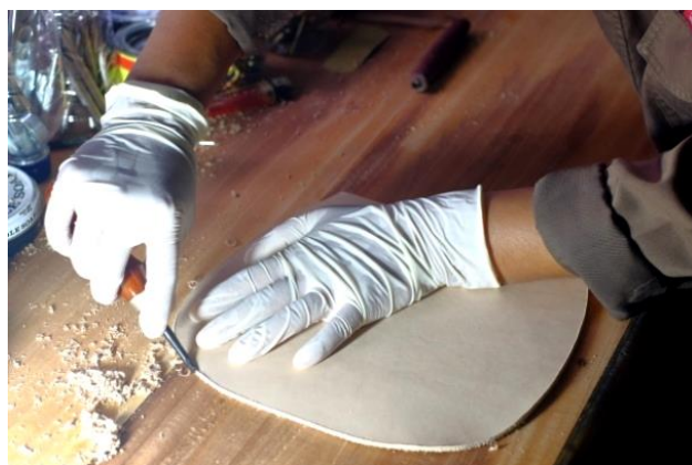
Gambar 97. Merapikan Tepi Tas Menggunakan Beveller (Dokumentasi Nova Mardiaty 2017)
