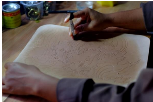
Gambar 90. Menyayat Kulit Menggunakan Swivel Knife (Dokumentasi Nova Mardiaty 2017)
