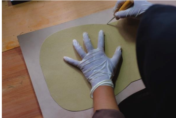
Gambar 86. Proses memindahkan Pola ke Kulit (Dokumentasi Nova Mardiaty 2017)
