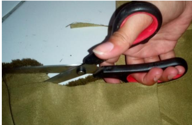
Gambar 103. Proses Menggunting Pola pada Kain (Dokumentasi Nova Mardiaty 2017)
