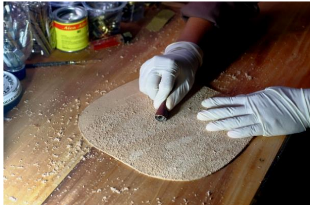
Gambar 94. Proses Mengamplas Kulit (Dokumentasi Nova Mardiaty 2017)
