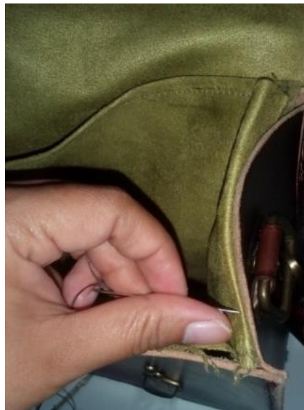
Gambar 107. Proses Menjahit Furing pada Tas (Dokumentasi Nova Mardiaty 2017)
