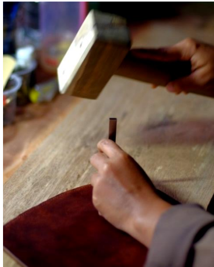
Gambar 98. Proses melubangi kulit (Dokumentasi Nova Mardiaty 2017)
