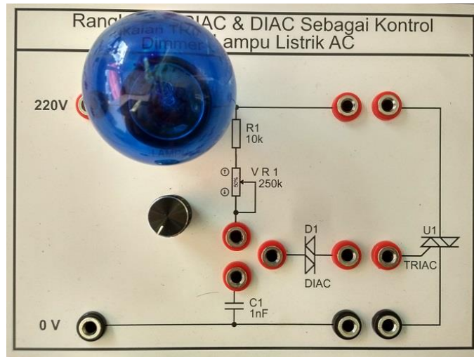
Gambar 14. rangkaian TRIAC & DIAC sebagai kontrol lampu AC
