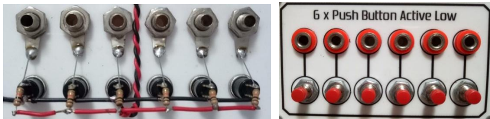
Gambar 13. Hasil Pengembangan Push Button Active Low
