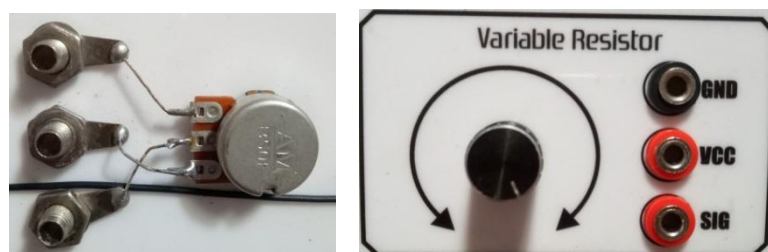
Gambar 17. Hasil Pengembangan Potensiometer
