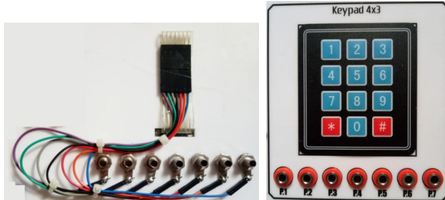
Gambar 20. Hasil Pengembangan Keypad 4x3
