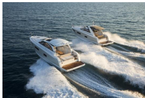
Gambar 4.13. Dua perahu bermotor dapat berbenturan karena berkurangnya tekanan air yang mengalir diantara keduanya.
