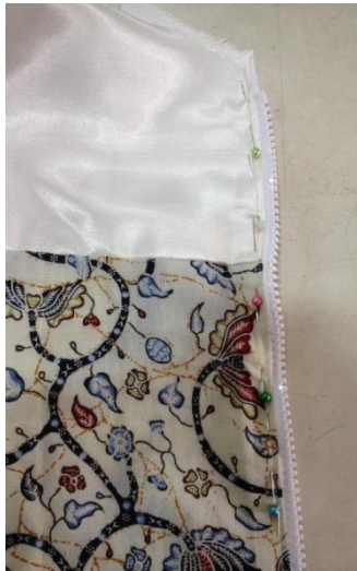
Gambar 4 tindas atau jahit resleting menggunakan sepatu satu, jahit resleting dengan jarak bahan dan resleting 3 mm ( gambar untuk bagian d )
