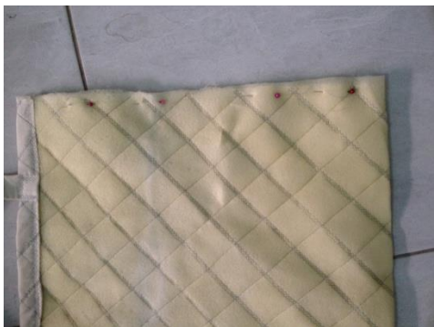
Gambar 4 sisi tas dijahit 1 cm ( gambar untuk nomer 6 )
