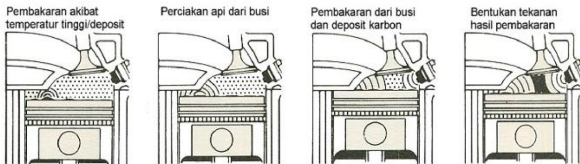
Gambar proses terjadinya pre-ignition
