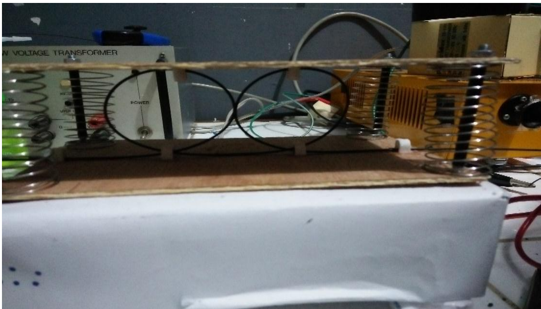
Lampiran 14. Gambar rangkaian penelitian fiber optik dibentuk 2 lingkaran
