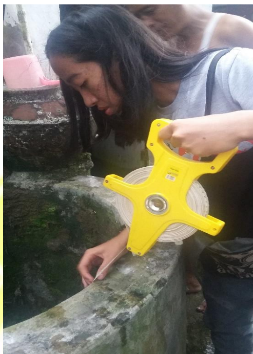
Gambar 7. Foto Pengukuran Kedalaman Muka Airtanah
