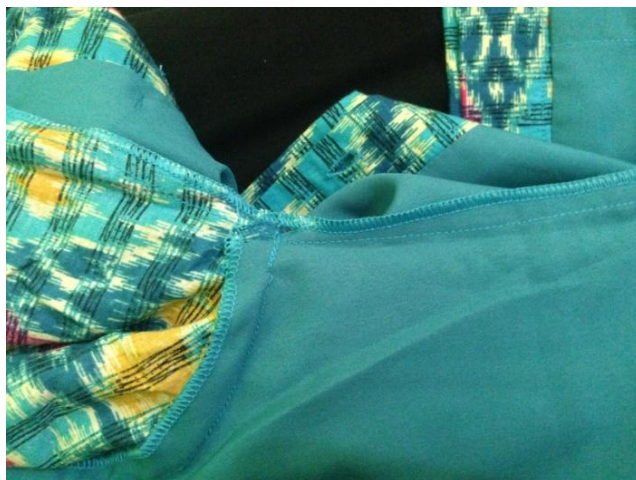
Gambar 7. Foto salah satu hasil praktek menjahit kemeja pria siswa kelas XI BA pada bagian krah kemeja yang tidak sama.
