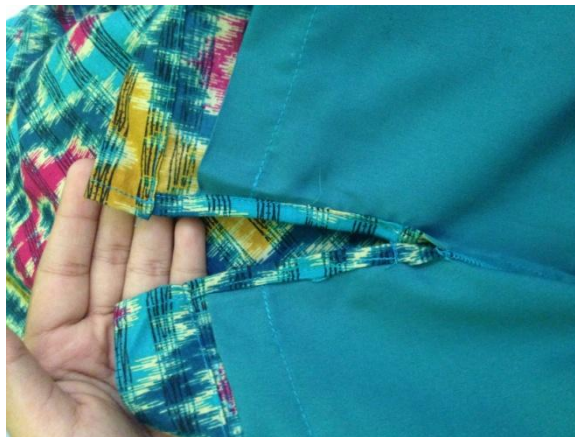
Gambar 6. Foto salah satu hasil praktek menjahit kemeja pria siswa kelas XI BA pada bagian belahan sisi yang tidak sama.
