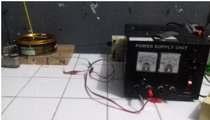
Gambar 30. Rangkaian alat pengukur intensitas keluaran keluaran fiber optik.
