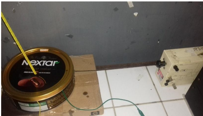
Gambar 31. Tempat minyak goreng, laser HeNe, dan fiber optik plastik yang melaluinya.
