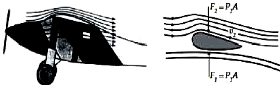
Gambar 1 . Garis-garis arus di sekitar sayap pesawat terbang.
