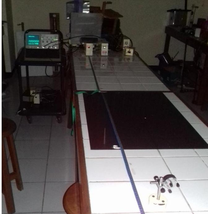
7. Hasil pengukuran waktu tempuh yang tampak pada layar CRO pada medium udara pada panjang lintasan 3,7 meter adalah 12 ns dengan perhitungan sebagai berikut :
