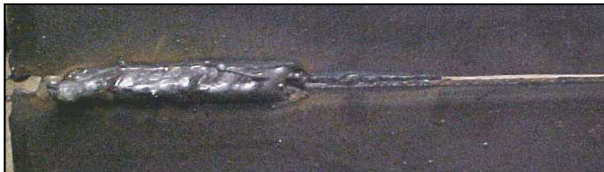
Gambar 2.8 Cacat penembusan yang kurang
