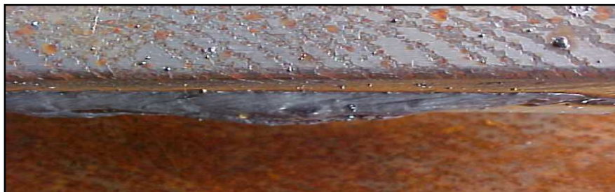
Gambar 2.11 Contoh cacat retak panas
