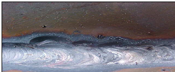
Gambar 2.2 Cacat las yang terlalu melebar
