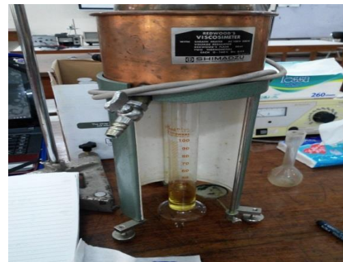
(Proses Pengukuran Viskositas)
