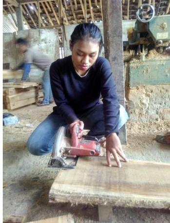
Gambar LX . Proses Pemotongan kayu dengan *hand saw*
