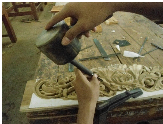
Gambar 29: Proses mbenangi dan mecahi (Dokumen Pribadi, 2017)
