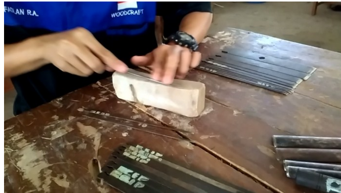
Gambar 20: Cara Mengasah Pahat Penguku (Dokumen Pribadi, 2017)
