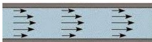
Gambar 2. Ilustrasi aliran laminer
