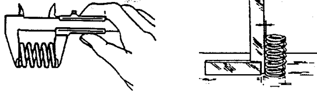
Pengukuran panjang dan kesikuan pegas penekan
