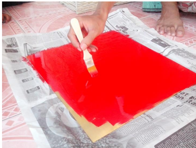
Gambar 23: Proses pelapisan plat dengan cat (Sumber: Dokumentasi Trihadi Nasrul Nita, 2017)
