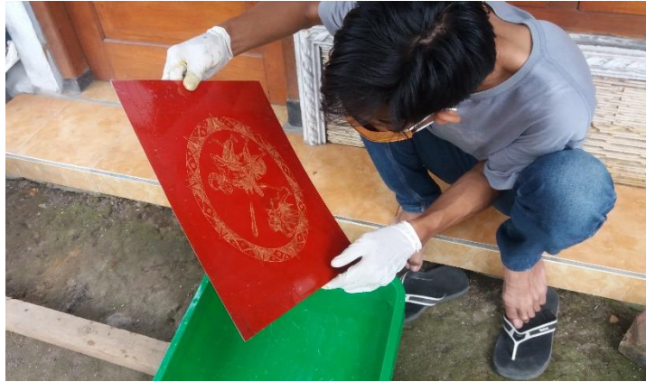
Gambar 29: Mengecek hasil etsa (Sumber: DokumentasiTrihadi Nasrul Nita, 2017)
