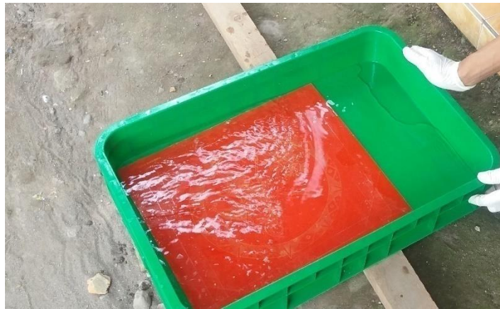
Gambar 30: Menetralsir hasil etsa dengan air bersih (Sumber: DokumentasiTrihadi Nasrul Nita, 2017)
