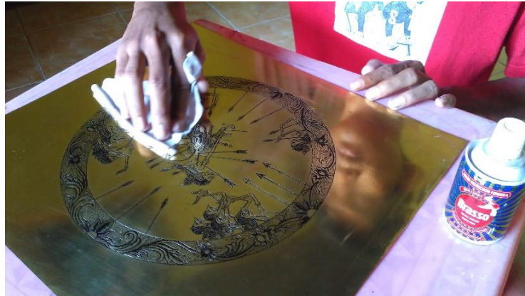
Gambar 35: Menggosok plat dengan Braso (Sumber: Dokumentasi Trihadi Nasrul Nita, 2017)
