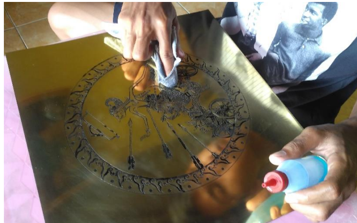
Gambar 34: Membersihkan tinta (Sumber: Dokumentasi Trihadi Nasrul Nita, 2017)
