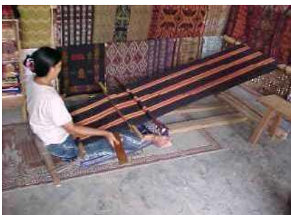
Gambar 25 Menenun Dengan Alat Tenun Gedog
