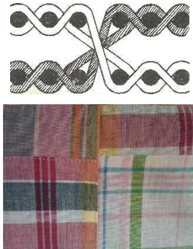
Gambar 12 Struktur dan Hasil Tenunan Kembar
