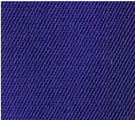
Gambar 6 Konstruksi Tenunan Silang Satin
