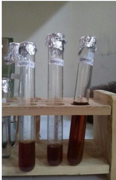
Gambar 14. Minyak jelantah yang telah diblender selama 1 jam, 2 jam, dan 3 jam (dari kanan ke kiri).
