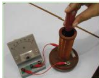
Gambar 13. Desain percobaan GGL induksi
