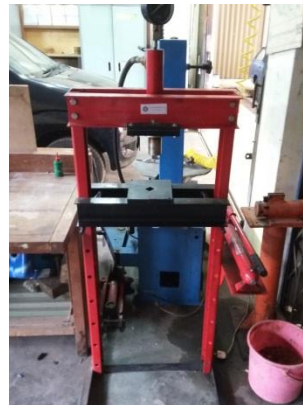
Pressure Machine dengan Pembebanan 20 Ton
