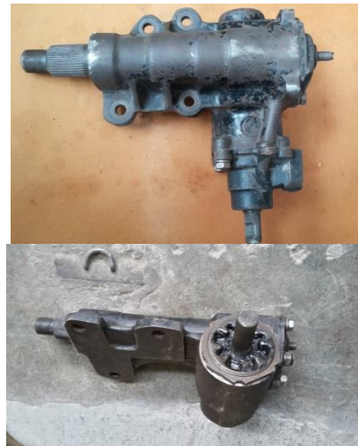
Media Roda Gigi Kemudi Tipe Worm And Pin Dan Worm And Roller
