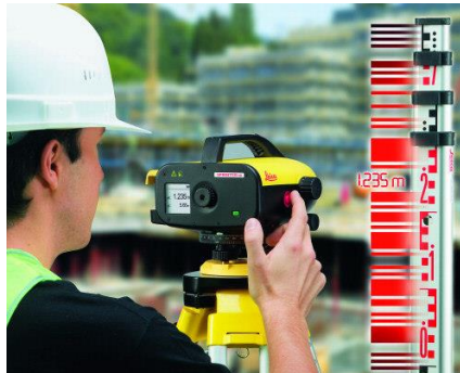
Gambar 16. Membidik Rambu Ukur Barcode dengan Waterpas Digital (sumber: http://www.vpcivil.co.in/ )
