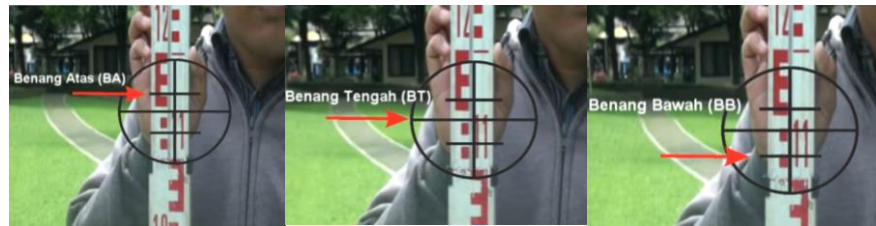
Gambar 9. Bacaan Benang Atas, Benang Tengah, dan Benang Bawah (Sumber: https://www.youtube.com/watch?v=25ID8TF_oAo )
