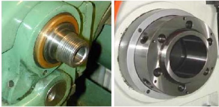
Gambar 19. Dudukan spindel mesin bubut bentuk ulir dan tirus
