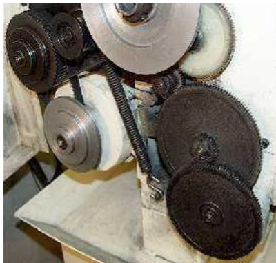
Gambar 3. System penggerak dan pengatur putaran mesin/ kecepatan pemakanan dengan roda pully dan sabuk V
