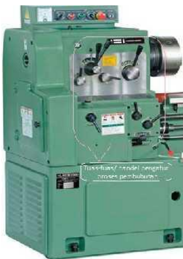
Gambar 11. Contoh posisi tuas-tuas pengatur kecepatan putar, feeding , penguliran dan pengubah arah pemakanan
