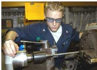
Gambar 37. Contoh penggunaan senter putar pada mesin bubut
