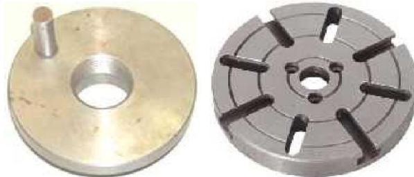
Gambar 25. Pelat pembawa permukaan bertangkai dan pelat pembawa permukaan rata
