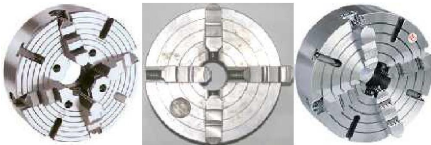
Gambar 16. Beberapa contoh cekam rahang empat tidak sepusat ( independent chuck )
