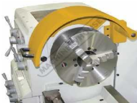
Gambar 2. Kepala tetap, terpasang cekam ( chuck )
