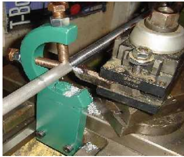
Gambar 33. Contoh penggunaan penyangga jalan
