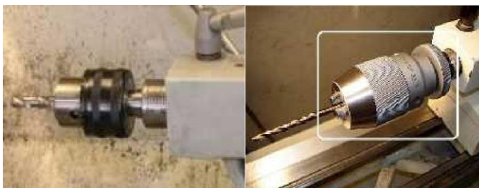
Gambar 40. Pemasangan cekam bor pada kepala lepas
