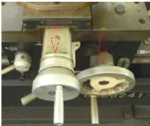
Gambar 9. Nonius pada roda pemutar eretan memanjang & melintang
