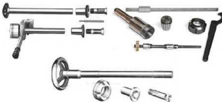
Gambar 21. Beberapa contoh cekam kolet dengan batang penarik
