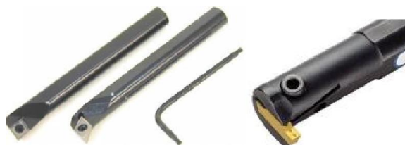
Gambar 10. Pahat bubut sisipan pengikatan diklem/ dibaut terpasang pada pemegangnya untuk pembubutan bagian dalam
