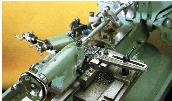
Gambar 29. Pembubutan lurus benda kerja ditahan dengan senter putar dan tengahnya ditahan dengan steady rest
