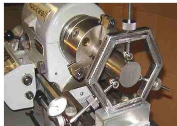
Gambar 15. Pemasangannya benda kerja berukuran panjang sebelum dibubut permukaannya
