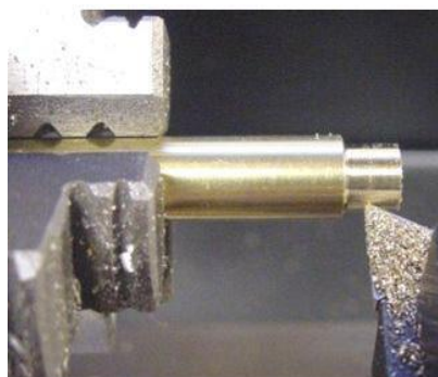
Gambar 27. Pembubutan lurus dengan cekam mesin
