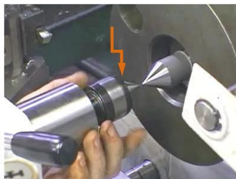
Gambar 21. Mengatur kesepusan sumbu dengan alat bantu batang pengetes dan dial indikator
