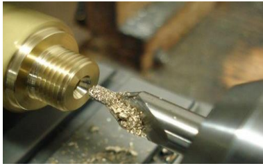
Gambar 19. Pembubutan lubang senter pada muka/ ujung benda kerja
