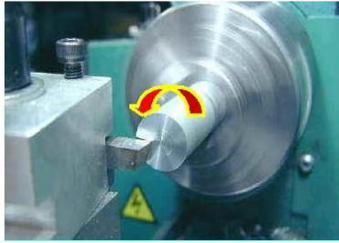
Gambar 16. Pembubutan muka start pahat bubut diawali dari sumbu senter benda kerja
