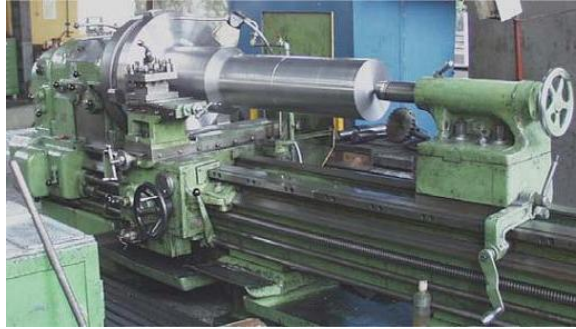
Gambar 28. Pembubutan lurus, benda kerja ditahan dengan senter putar
