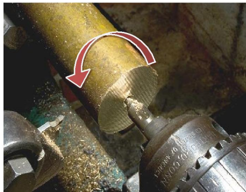
Gambar 25. Putaran mesin bubut harus berlawanan dengan mata sayat bor senter
