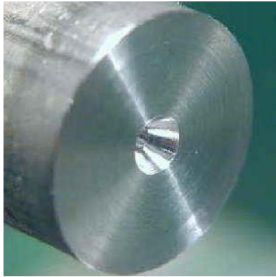
Gambar 26. Dimensi bor senter ( centre drill ) dan hasil pembubutan lubang senter bor
