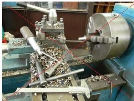
Gambar 5. Penempatan peralatan kerja yang tidak aman
