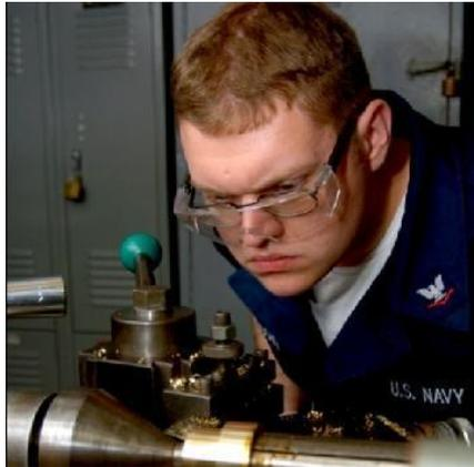
Gambar 2. Menggunakan kaca mata yang standar pada saat proses pembubutan
