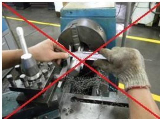
Gambar 9. Menggunakan sarung tangan pada saat melakukan pembubutan
